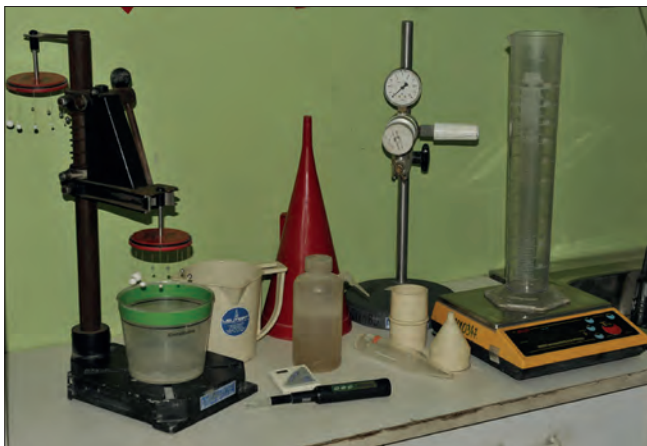
Rys. 5. Przykład zestawu przyrządów do kontroli właściwości zawiesiny na budowie
