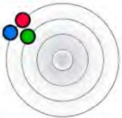
WYSOKA PRECYZJA ALE NISKA DOKŁADNOŚĆ (precise but not accurate)
