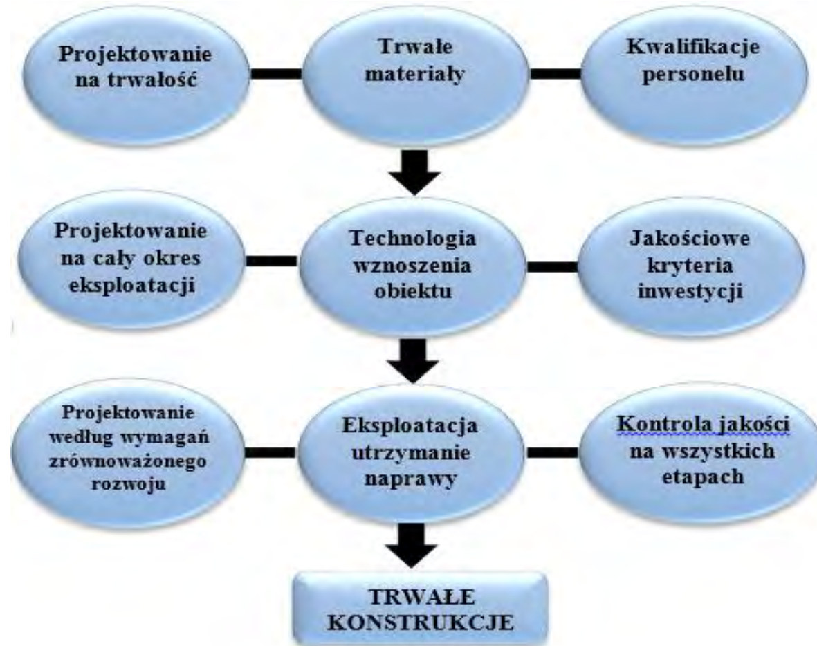
Rys. 2 Schemat grup zagadnień związanych z trwałością konstrukcji
