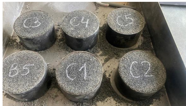
Fot. 2. Próbki zapraw CPG w formach o średnicy 100 mm i wysokości 63 mm.
