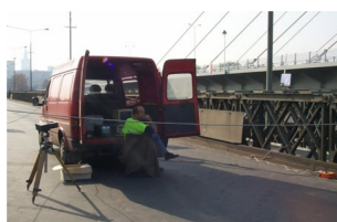
Fot. 7. Pomiar naprężeń z zastosowaniem elektrycznej tensometrii oporowej.
