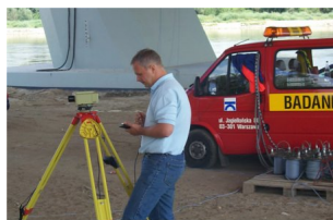
Fot. 5. Pomiar przemieszczeń podpór z zastosowaniem niwelacji geometrycznej przy użyciu cyfrowego niwelatora precyzyjnego (LEICA).
