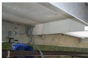
Fot. 6. Pomiar przemieszczeń pionowych i poziomych przy użyciu automatycznego tachimetru elektronicznego (LEICA).
