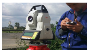
Fot. 5. Pomiar przemieszczeń podpór z zastosowaniem niwelacji geometrycznej przy użyciu cyfrowego niwelatora precyzyjnego (LEICA).
